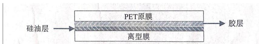
图 3-3 不干胶标签双层结构示意图
